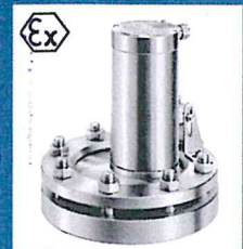
(Ex-)Schauglasleuchten in Voll-Edelstahl-Ausführung bis 50 W, 12 bis 240 V, bis T6, EEx d IIC, II 2 G+D
